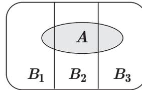
$$P(A) = P(A \cap B_1) + P(A \cap B_2) + P(A \cap B_3) = \\ = P(B_1) \times P(A | B_1) + P(B_2) \times P(A | B_2) + P(B_3) \times P(A | B_3)$$
